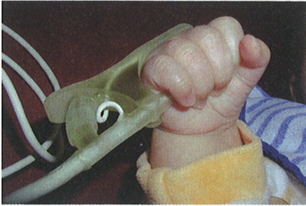
Der Sensorkopf nutzt den natürlichen Greifreflex von Säuglingen und Kleinkindern, um rasche und zuverlässige Messwerte zu erzielen (Foto: ©SIGNO Erfinderclub Neckar-Odenwald-Kreis).
